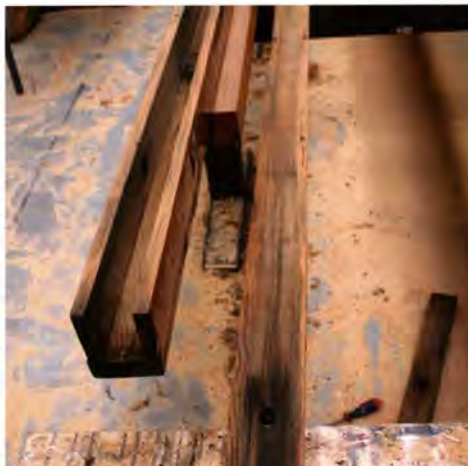
Bijgaande opnamen van gedelamineerde masten zijn gemaakt bij Ventis Scheepstimmerwerk. Inmiddels zijn ze weer als nieuw gemaakt en kunnen ze weer jaren mee.
